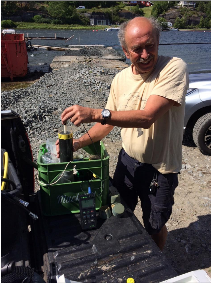
Bilde 5: Hartvig fra NIVA måler red/ox nivå i sedimentprøver på feltdag 25.06.17. Foto GEP.
