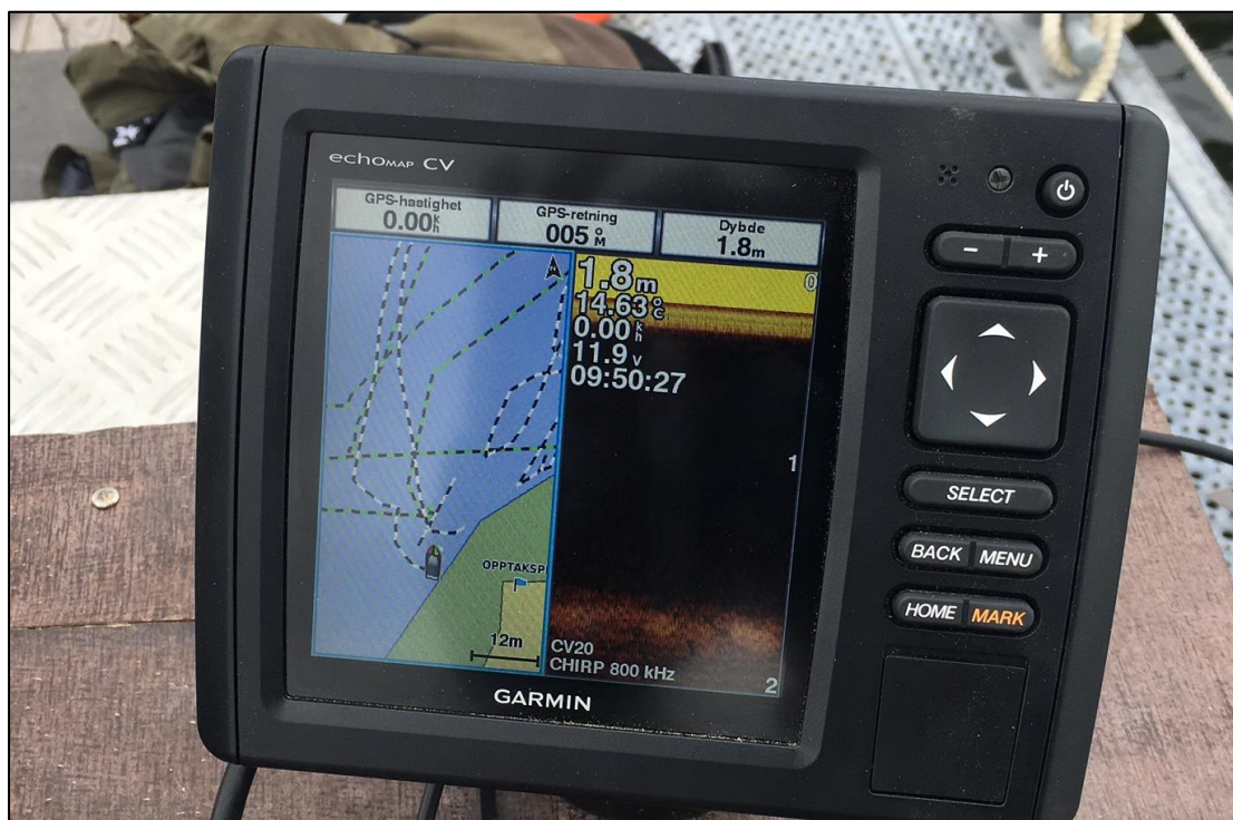
Bilde 2: GARMIN SHIRP 52 kartplotter/ ekkolodd er nå montert på SLIKKEN:
