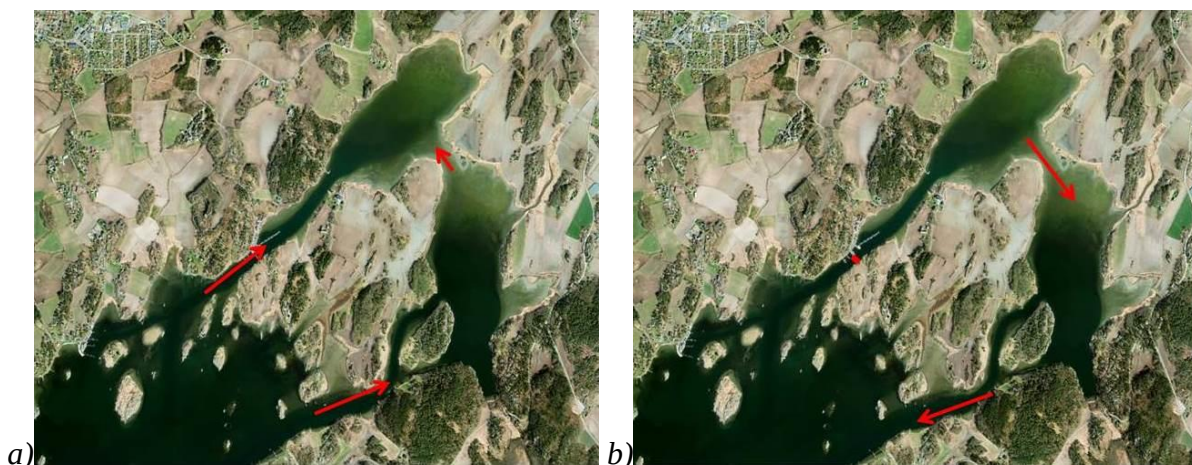
Figur 5: Hovedsirkulasjon med tidevannsport i Viksfjorden som stenges på flo sjø og åpnes på fjære sjø, for a) stigende vannstand og b) fallende vannstand.
