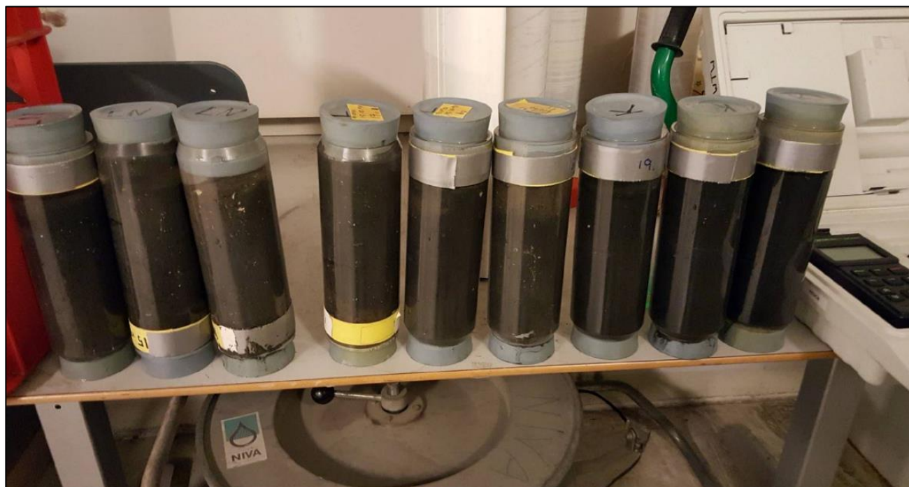
Bilde 9: Sedimentprøver fra luftet og kontrollområde. 3 prøver til venstre er førstegangsluftet område, 3 i midt er luftet flere ganger mens 3 til høyre er kontroll/ uluftet. En ser tydelig at luftet område får lysere farge som tilsier bedret kvalitet.
