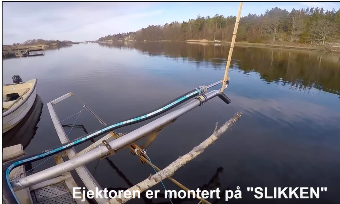
Figur 22: Ejektor montert på «SLIKKEN», klar til etablering av prøvefelt.
