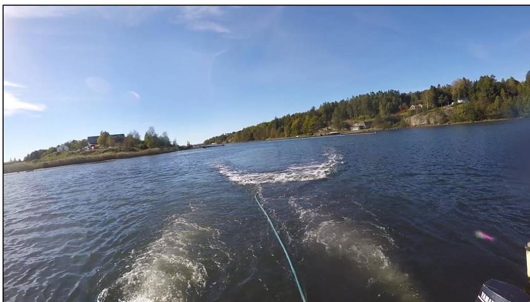
Figur 11 Sleden er her på ca 2,5m dyp og følger stabilt og fint etter SLIKKEN
