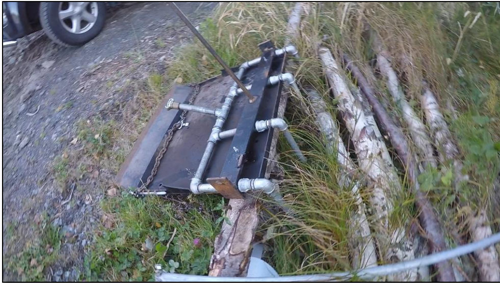
Figur 4 Injiseringssleden som ble laget og benyttet under operasjonen.
